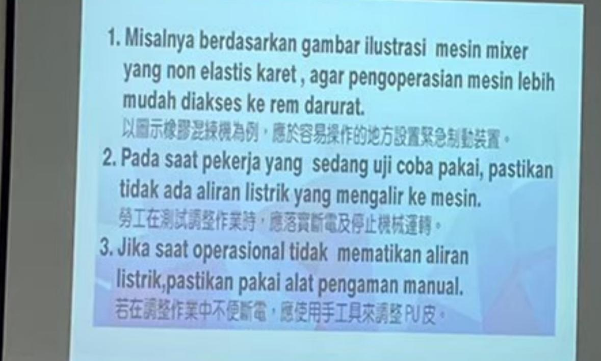
1. Misalnya berdasarkan gambar ilustrasi mesin mixer yang non elastis karet, agar pengoperasian mesin lebih mudah diakses ke rem darurat.
