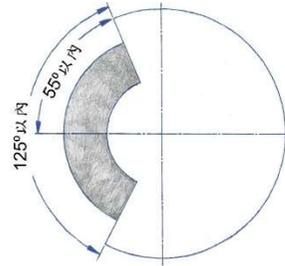
五、使用研磨輪上端為目的之桌上用研磨機或床式研磨機
